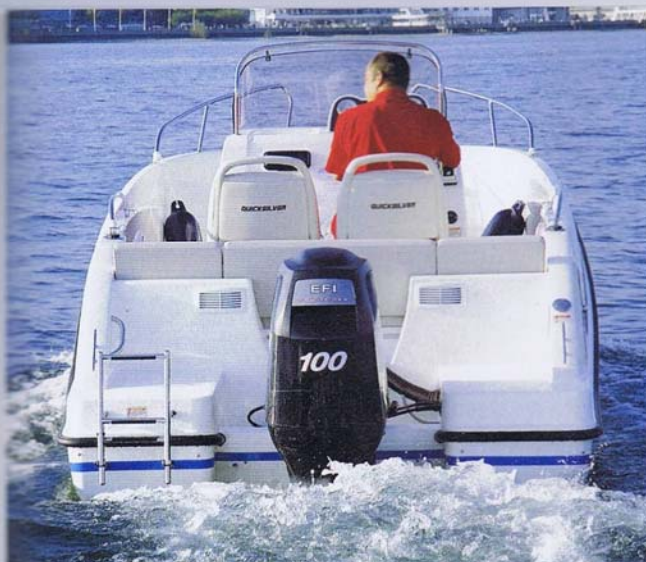
Die zu beiden Seiten der Motorwanne angeordneten Heckstege sind rutschhemmend strukturiert. Die Trittfläche misst 56 x 42 cm
