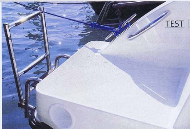
Die zu beiden Seiten der Motorwanne angeordneten Heckstege sind rutschhemmend strukturiert. Die Trittfläche misst 56 x 42 cm
