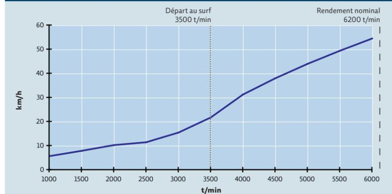
Point mort: 750 t./min, vitesse max.: 57,4 km/h à 6200 Ut./min, mesuré avec le GPS, 2 personnes à bord, pas de vent, pas de vague.
